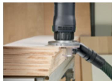
Фрезерование пластмассовой или деревянной кромки.
