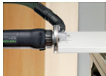
Скругление пластмассовой или деревянной кромки.
