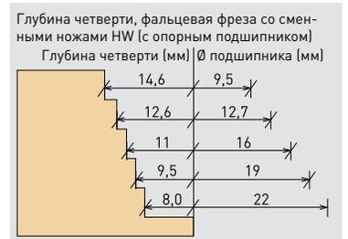
\*\* Комплект поставки: комплект опорных подшипников от Ø 9,5 мм до Ø 22 мм
