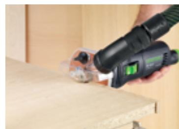
Фрезерование пластмассовой или деревянной кромки заподлицо.
