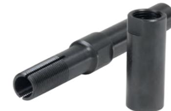
Удлинитель-переходник с диаметра хвостовика S=12 мм на диаметр хвостовика d=8 мм. Позволяет «добавить» примерно 80 мм к стандартному вылету фрезы. Применяется для работы с ручным фрезером. С его помощью легко фрезеруются глубокие пазы, например, для дверных замков или шиповых соединений.
