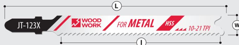
Разработаны специально для резки стали, цветных металлов, а также пластика. Осуществляют агрессивный рез. Подходят для резки листового материала до 10 мм, труб и профилей.
