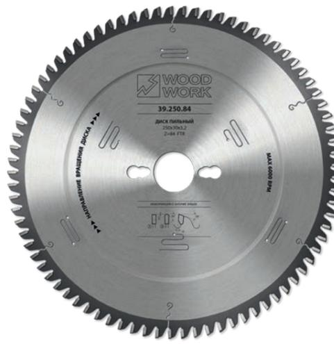
Пильные диски **серии 39** предназначены для раскроя ЛДСП на пильных и форматно-раскrojных станках. Это высококачественная линейка пильных дисков с отрицательным передним углом и формой заточки прямой-трапеция:
