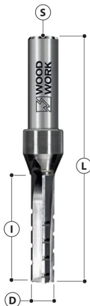
Монолитные твердосплавные пазовые фрезы серий **909** и **910** изготовлены из ультрамелкозернистого твердого сплава с твердостью **94 HRA**. Эти фрезы можно использовать для обработки твердых пород древесины, МДФ, ДСП и фанеры. Фрезы изготовлены из монолитного прутка, что обеспечивает повышенную жесткость, уменьшает вибрации при фрезеровании и гарантирует более долгий срок службы по сравнению с фрезами серии **911**.
