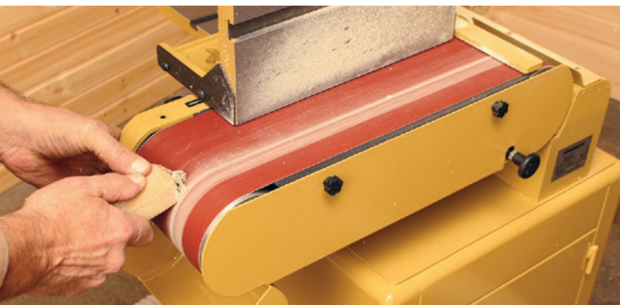
Чистящий карандаш Jet позволяет в считанные секунды «обновить» ленту или круг, почистив их от мелкой древесной пыли. Это не только удобно, но заодно увеличивает ресурс абразивного материала и улучшает качество обработки следующих заготовок
