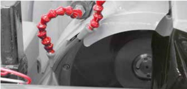
Применение смазывающе-охлаждающей жидкости при заточке чрезвычайно важно:
