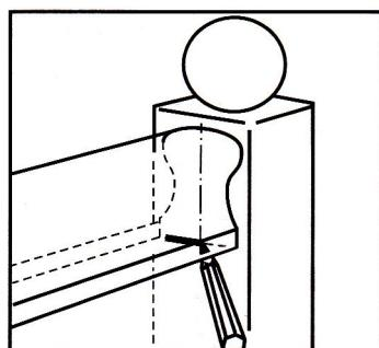
3. Отметьте требуемое положение поручня на столбе по нижней границе и по вертикальной оси.
