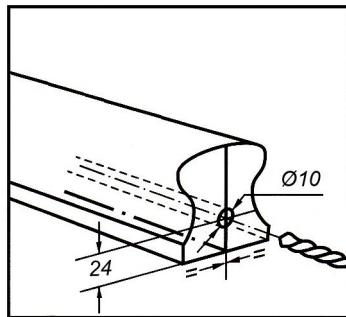
1. Сделайте разметку на торце поручня и просверлите отверстие Ø10 мм и глубиной 60 мм.
