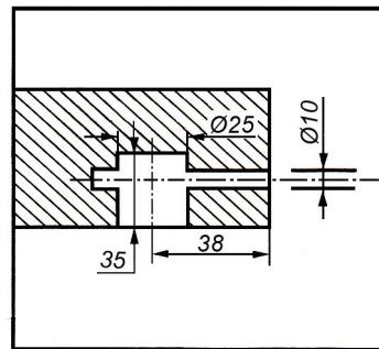
2. Сделайте разметку и просверлите отверстие Ø25 мм и глубиной 35 мм в нижней части поручня.
