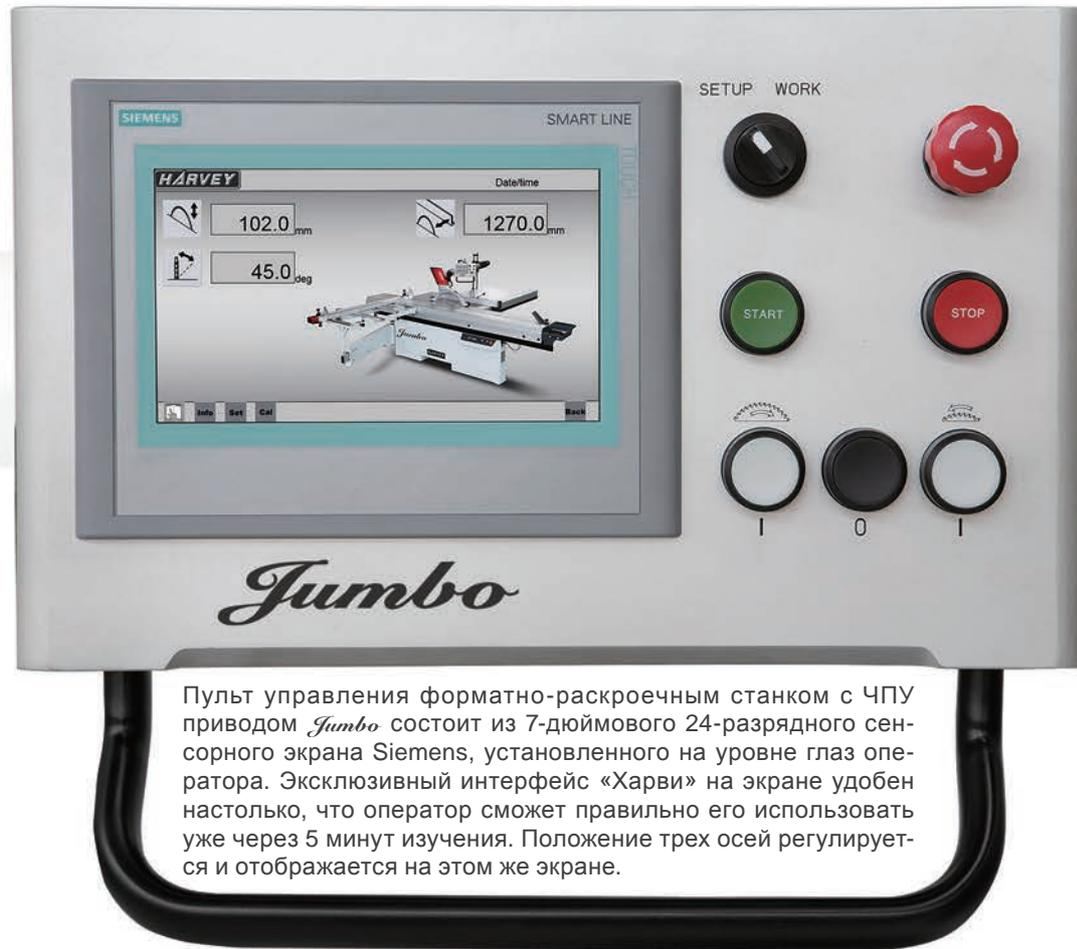
Пульт управления форматно-раскrojным станком с ЧПУ приводом *Jumbo* состоит из 7-дюймового 24-разрядного сенсорного экрана Siemens, установленного на уровне глаз оператора. Эксклюзивный интерфейс «Харви» на экране удобен настолько, что оператор сможет правильно его использовать уже через 5 минут изучения. Положение трех осей регулируется и отображается на этом же экране.
