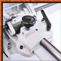
Параллельный упор с реечной передачей
