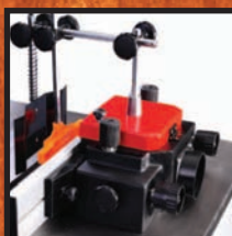
Параллельный упор с защитой зоны реза
