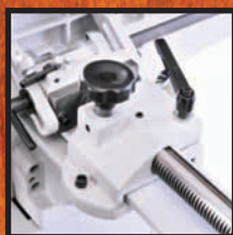
Параллельный упор с реечной передачей
