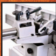
Параллельный упор с реечной передачей
