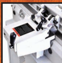
Параллельный упор, расположенный по центру
