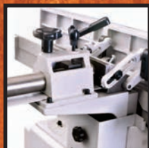
Параллельный упор с реечной передачей
