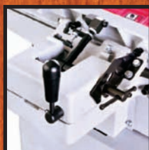
Параллельный упор, устанавливаемый по центру
