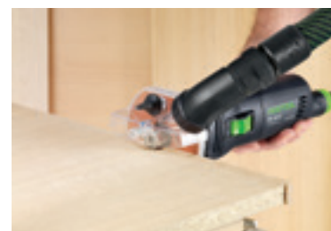
Фрезерование пластмассовой или деревянной кромки заподлицо.
