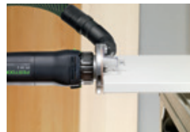
Скругление пластмассовой или деревянной кромки.
