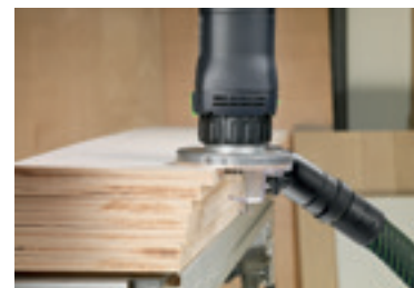
Фрезерование пластмассовой или деревянной кромки.
