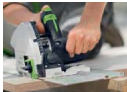
Быстрая и аккуратная распиловка материала: шина-направляющая плюс погружная пила.
