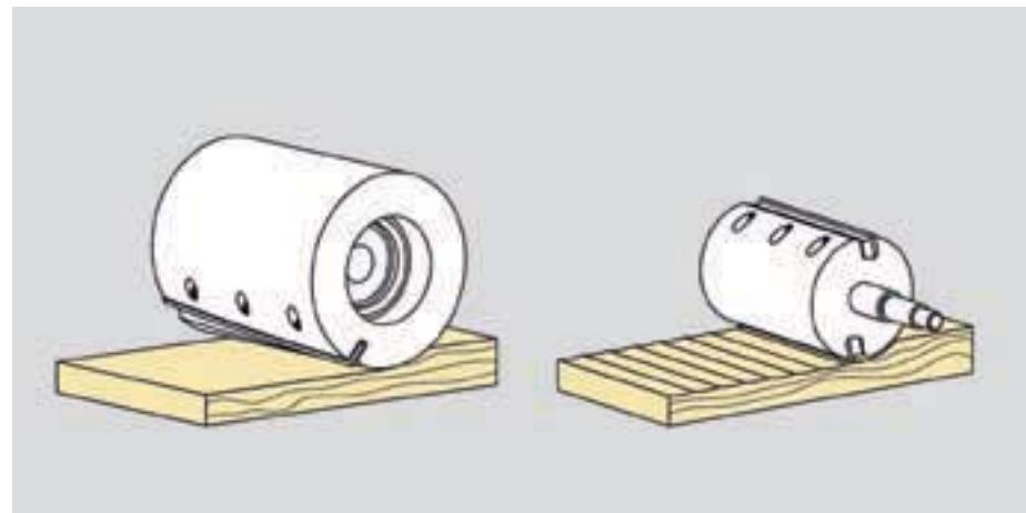
Не имеющая аналогов концепция спирального ножа Spir-O-Cut: «тянувший рез» рубанков Festool обеспечивает гладкую поверхность без зазубрин – и все это при низком уровне шума.
