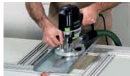
Фрезерные салазки MFS-FS позволяют просто и чисто работать фрезером на плоской поверхности.
