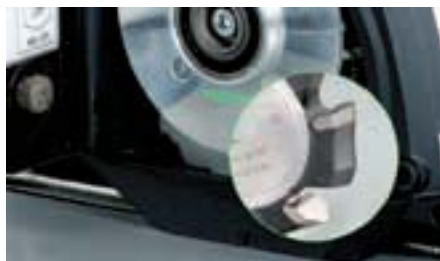
Дисковая фреза и контактный ролик сменные. Тем самым PF 1200 можно в любое время настроить на соответствующую толщину обрабатываемого материала.
