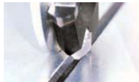
С помощью контактного ролика надежно устанавливается точная глубина фрезерования. Фреза погружается в материал ровно настолько, насколько это позволяет контактный ролик.
