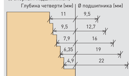
Глубина четверти, фальцевая фреза HW (с опорным подшипником)
