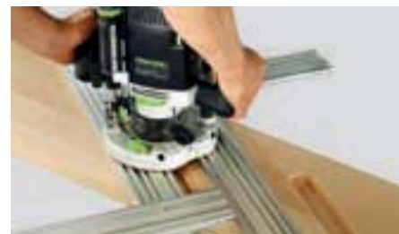
С помощью MFS можно так же точно фрезеровать пазы под ступени в тетиве лестницы.
