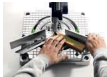
Малка и запатентованный упор: SYMMETRIC работает точно и просто.
