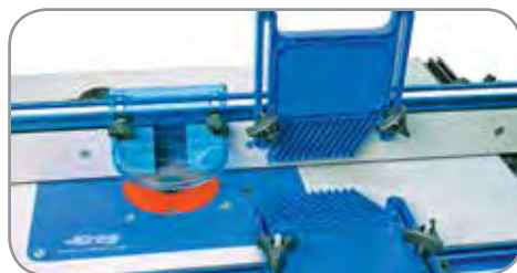
Вертикальное и горизонтальное расположение демонстрирует совместимость системы крепления с П-образной и Т-образной направляющими.
