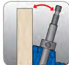
Оптимизированный угол сверления
