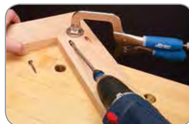
Шурупы Крэг выпускаются в большом диапазоне длины, как с крупной, так и с мелкой резьбой, для применения с древесиной различного вида. (Подробнее на стр. 18)
