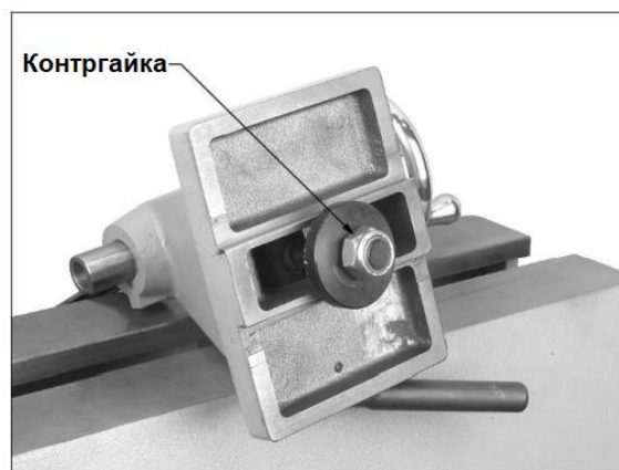
Рисунок 8-3: регулировка зажимного эксцентрика
