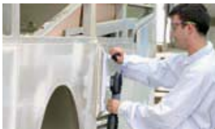
Машинка LRS 400: разработана и изготовлена для того, чтобы легче было обрабатывать большие поверхности – и плоские, и профильные.
