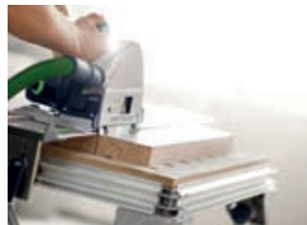
Надежное крепление и уверенное ведение: погружные пилы в комбинации со столом MFT.
