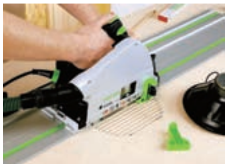
Пиление без сколов с обеих сторон благодаря шине-направляющей и противоскольному вкладышу.
